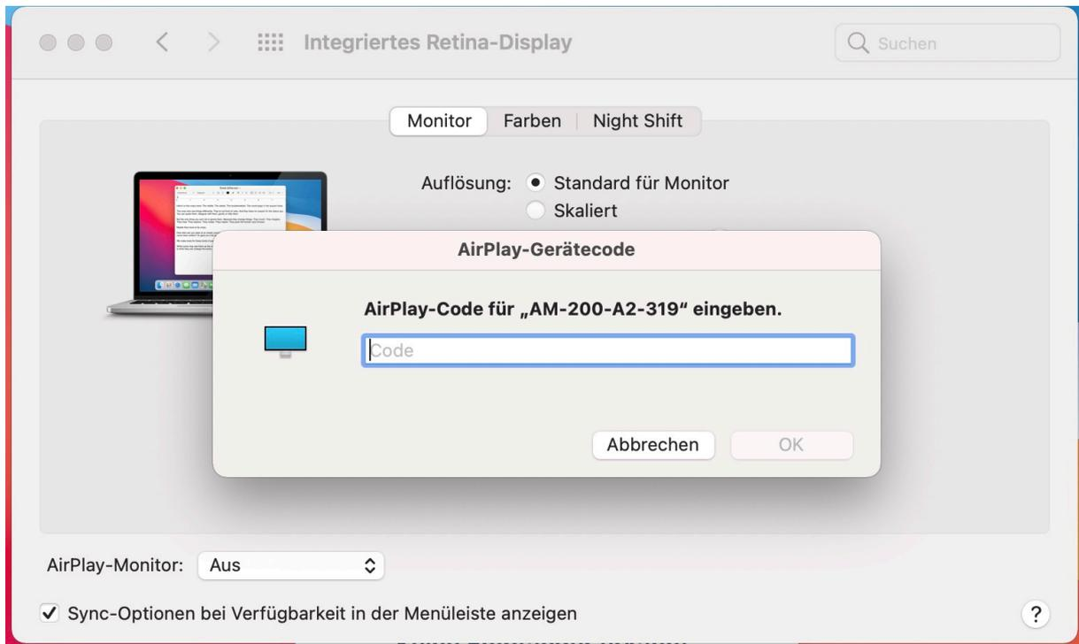
12. Jetzt wird der Computerbildschirm auf dem Beamer per AirMedia angezeigt. Ggf. müssen noch die Einstellungen für gespiegelten, bzw. erweiterten Bildschirm in den Display-Einstellungen angepasst werden.
